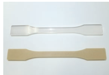
成形例 (上:生分解性樹脂ペレット単独) (下:パルプを複合したもの)
